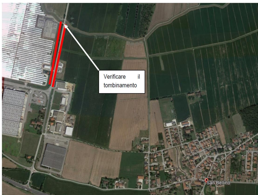
Figura 19 – Individuazione in rosso delle affossature da manutenzione ed in magenta del tratto tombinato da verificare
